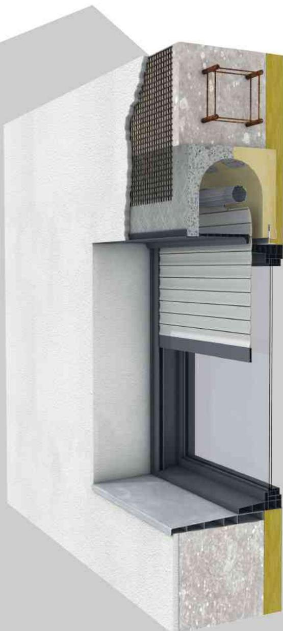
**Winbox est un caisson de volet roulant préfabriqué, réalisé par moulage destiné à être incorporé à des murs en maçonnerie. Il est composé de trois éléments : polystyrène, rail Aluminium et armature.**
